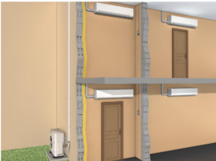
L'unité extérieure s'installe sur une dalle béton a l'extérieur de l'habitat , reliée à l'unité intérieure par des liaisons frigorifiques qui permettrons de faire circuler le gaz.
